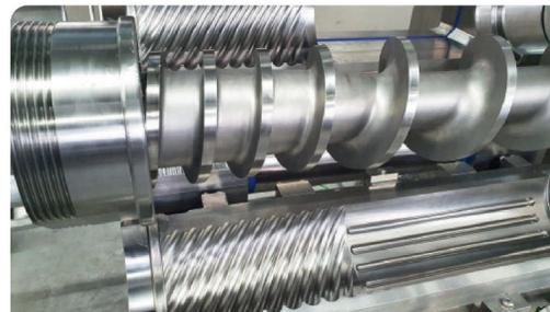
Die Arbeitsschnecke wurde speziell auf die größtmögliche Ausbringung berechnet. Im geöffneten Gehäuse ist auch die Vorschneidegeometrie zu sehen.
