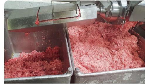
Beim Zerkleinern von Hähnchenkarkassen ist das Verhältnis Gutproduktion (rechts) zu Ausschleusung (links) gut zu erkennen. Es wurde bis zu 15% mehr Gutaussbeute im Vergleich zu bisherigen Separatoren erzielt.
