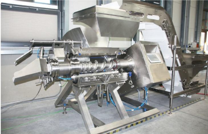
In der Reinigungsposition ermöglichen das offene Gehäuse und die angehobene Schnecke eine direkte, schnelle und gründliche Reinigung. Alle zu reinigenden Stellen sind einsehbar und ohne Tritt oder Leiter erreichbar.
